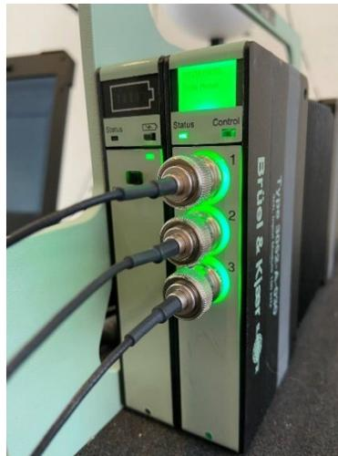
**Figura A18:** Indicador de estado correcto, para 3 canales en LAN-XI 3052.
