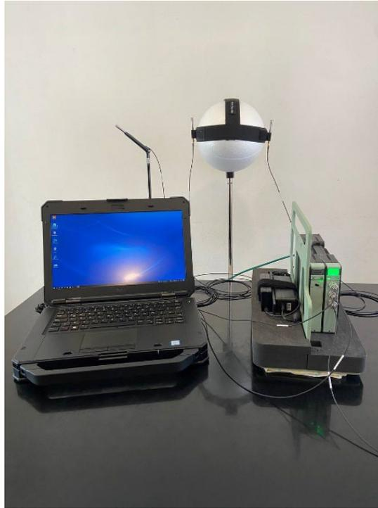
**Figura A12:** Montaje típico de sistema de evaluación de ruido impulsivo.
