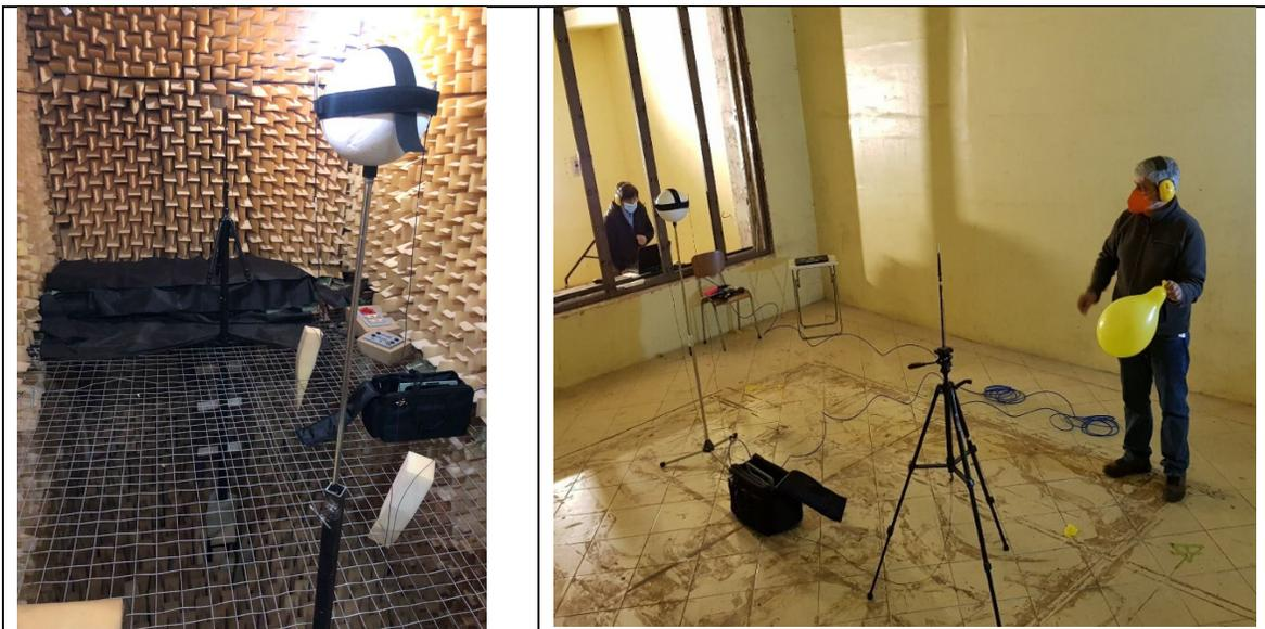
**Figura 6:** Fotografías que muestran el arreglo experimental para medir ruido impulsivo dentro de la sala anecoica (izquierda) y la sala reverberante (derecha).
