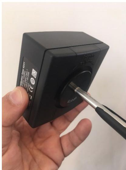
**Figura A20:** Micrófono 4944-A conectado a calibrador.
