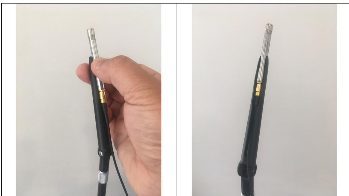
**Figura A23:** Montaje de los micrófonos 4944-A en trípode.
