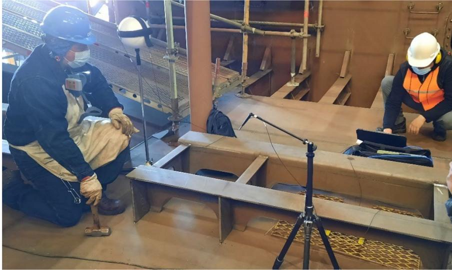
**Figura 7:** Medición ruido impulsivo en los astilleros de ASENAV, Valdivia.
