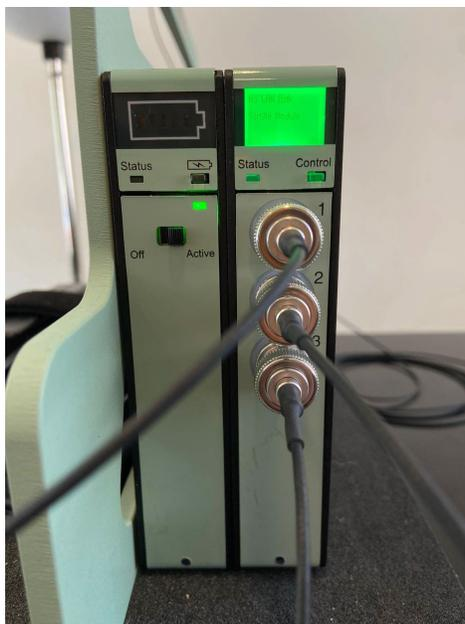
**Figura A13:** Módulo de adquisición LAN-XI 3052 con batería type 2831.
