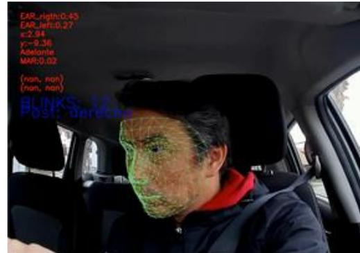
Figura 6.7: Detección de rostro del conductor - Vista lateral (derecha)
