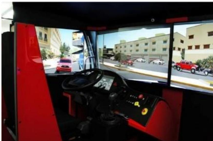
Figura 5.1: Cabina de simulación Inatrans.
