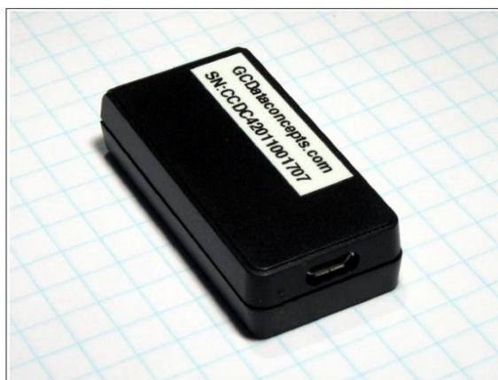
**Figura 4.- Acelerómetro triaxial digital utilizado**
