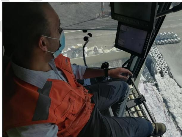
**Factores de riesgo:** El operador no puede elegir el ritmo de trabajo, la vibración está presente en la cabina y se hace sentir al momento que el spreader telescópico sujeta el contenedor y comienza el izaje de la carga. En la operación debe manipular dos Joystick y apretar los botones que se encuentran en la parte superior de éstos; a la izquierda tiene una pantalla de visualización. El
