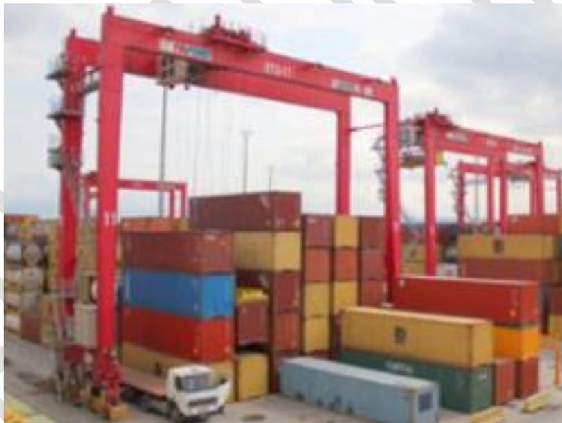
Esquema grúa Rubber Tyred Gantry (RTG) 1) Traslación del pórtico: desplazamiento de la grúa sobre ruedas, 2) Elevación y descenso del spreader, 3) Traslación del carro
