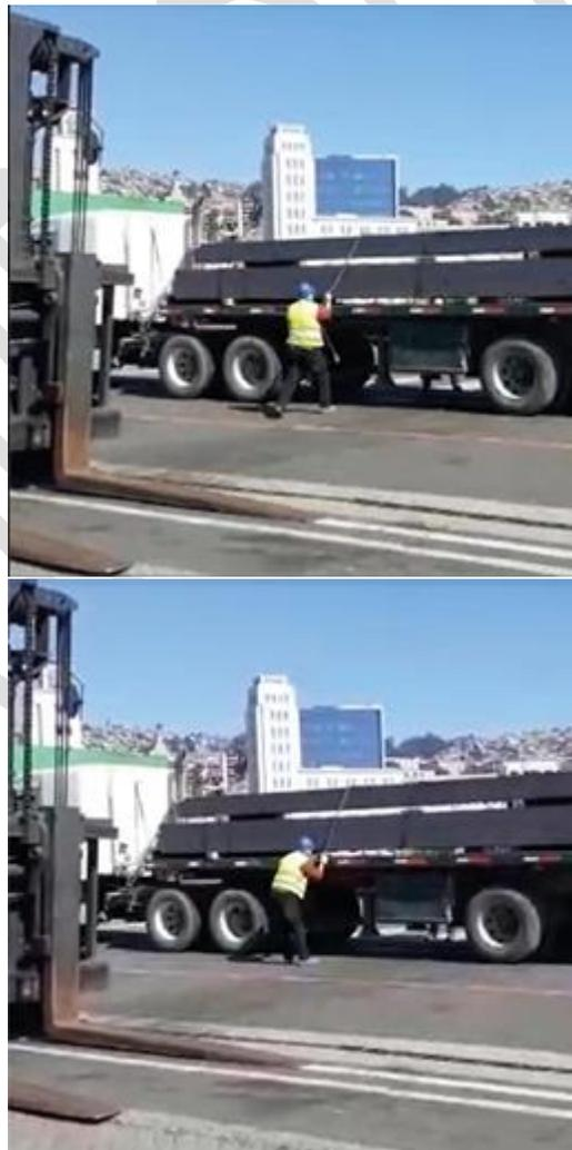
Una vez tensada la cadena manualmente, toma el gancho que tiene la cadena en su eslabón final y lo engancha en el camión. Enseguida, el movilizador procede a preparar el teclé de palanca (“la señorita”), para instalarlo en la cadena y terminar la trinca.
