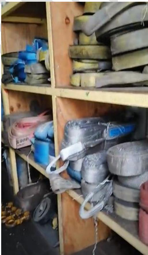
**Fotografía 5:** Faja de poliéster que puede llegar a soportar 10 toneladas. Peso aproximado de 3 kilos.
