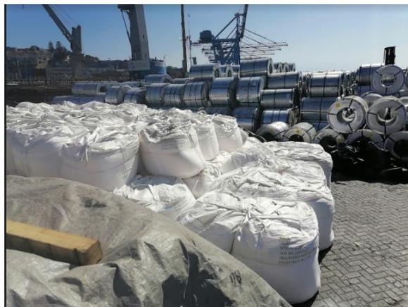
Para transportarlos a los camiones que los despacharán, los movilizadores se suben a los Big Bag y enganchan las cintas de éstos en las uñas de la grúa horquilla, para levantarlos. Enganchan un Big Bag por cada uña. Una vez que la grúa horquilla los levanta, se los lleva a otro sitio para el despacho. Carga 2 Big Bag por uña, es decir, transporta aproximadamente 2 toneladas.
