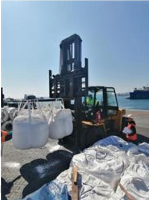
**Fotografía 2:** Se aprecia la visión anterior dificultosa que tiene el operador de la grúa horquilla.
