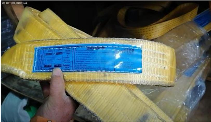
**Fotografía 6:** Faja tubular de alta densidad, es capaz de levantar 40.000 kilos.
