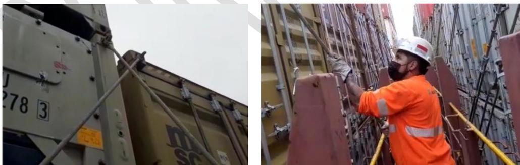
Luego, procede a ajustar la varilla con el tensor que se encuentra enganchado en el puente de la embarcación. Una vez ajustados, sube un pasador que los mantiene unidos. Es una operación muy breve, sin riesgo.
