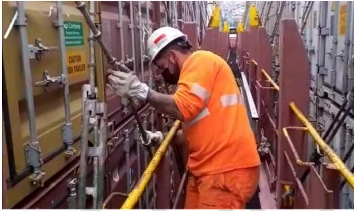
En la operación siguiente se realiza la trinca manual, que consiste en enroscar el tensor en la varilla. El trabajador enrosca ambas estructuras metálicas para que queden firmes. Esta labor se realiza con ambas manos, muñecas en flexión de 30° y extensión de 40° repetitiva, antebrazos en pronación, codos flectados, hombros en flexión de 10°.
