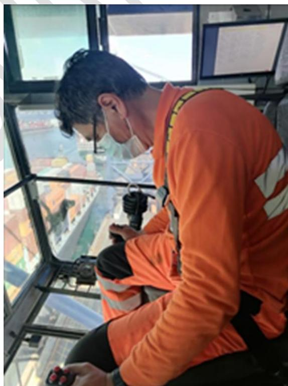
**Fotografía 4:** Se aprecia la visión inferior que tiene un operador de grúa STS. En rojo se ve el spreader que iza y baja los contenedores.
