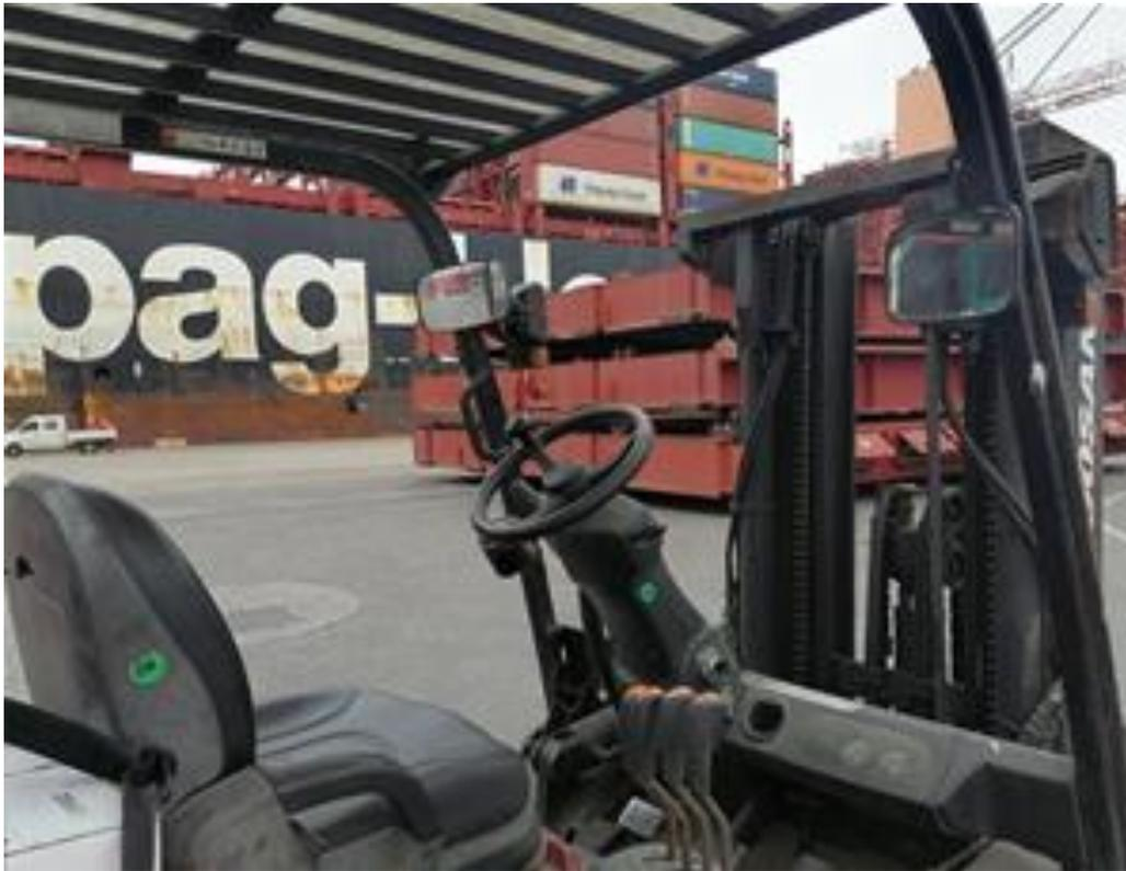
**Fotografía 5:** se aprecia la cabina de operaciones de una grúa horquilla de alto tonelaje. Está vidriada por anterior, lateral y posterior al operador. Se aprecian las palancas al lado derecho del conductor, y el manubrio con pomo que opera con la mano izquierda.
