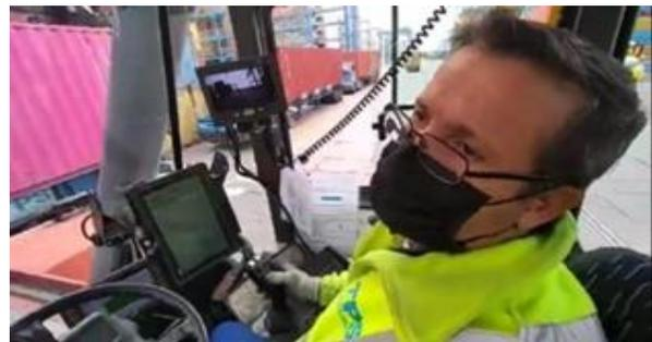
**Fotografía 4.** Se aprecia la visión hacia anterosuperior del trabajador. Se observa el spreader del equipo en la parte superior de la fotografía que el trabajador acerca al contenedor para tomarlo. Nótese la dificultad que tiene para observar hacia la izquierda por uno de los cilindros elevadores del equipo. La máquina posee dos cilindros elevadores por anterior, a izquierda y derecha.
