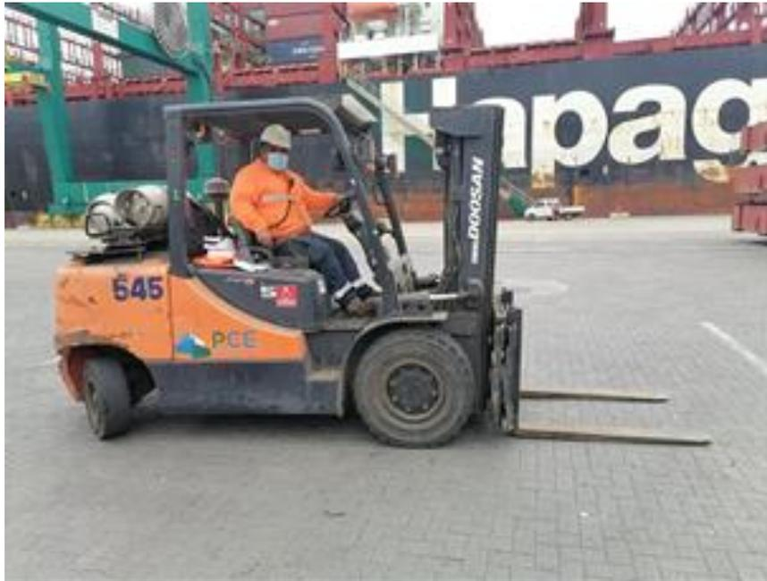
**Características de la Cabina:** Existen cabinas vidriadas en el frente donde va el parabrisas, en los costados derechos e izquierdo, en la parte posterior y el techo, el cual tiene un enrejado de fierro para protección del operador. Algunas grúas horquillas más pequeñas, sólo cuentan con enrejado en su techo, sin vidrios por anterior, posterior y lateral.
